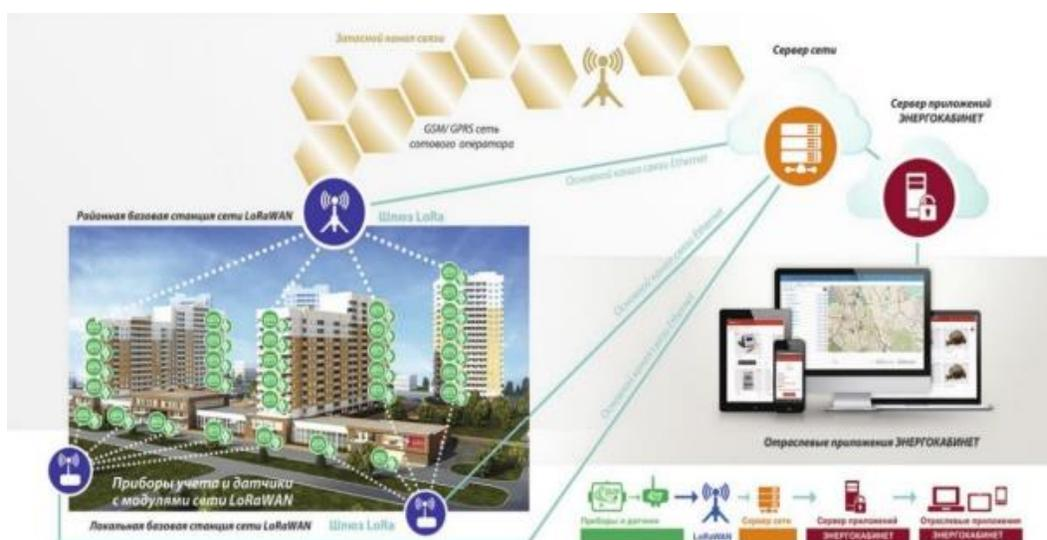
Рисунок 2 – Концепция обмена данными в сетях LoRaWAN
